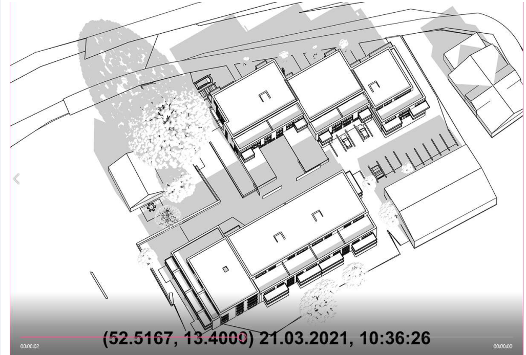
Abb. Mögliche Verschattung 21.03. 10:36 (Rest des Tages unverschattet)
